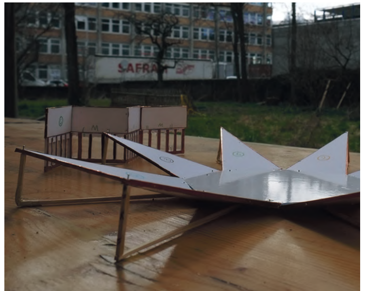
Essais au 1/100 e , balsa, carton plume, clous, scotch adhésif, cuivre.
