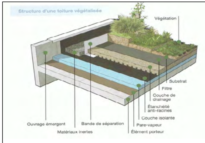
Structure d'un toit végétal.
