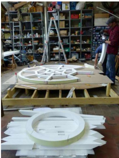
Assemblage de l'enrayure - Assemblage de l'une des 8 faces de la tour. N.B : Le montage de chaque face doit être précis pour faciliter le montage final.
