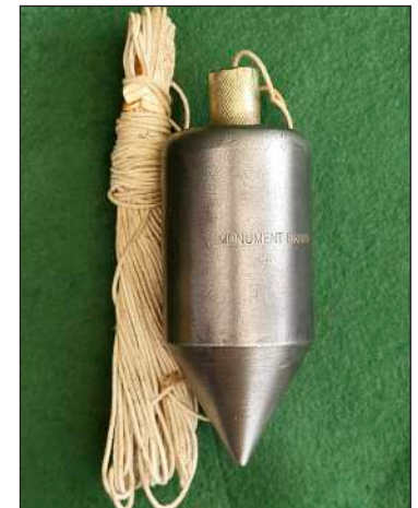
Exemple de Fil à plomb ancien de presque 2 Kg
