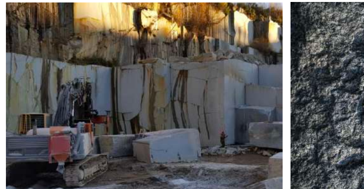
Granit breton de LOUVIGNÉ- Masse volumique de 2600 Kg / m 3 : 2,5 m x 1,5 m x 0,08 m = plus de 700 Kg
